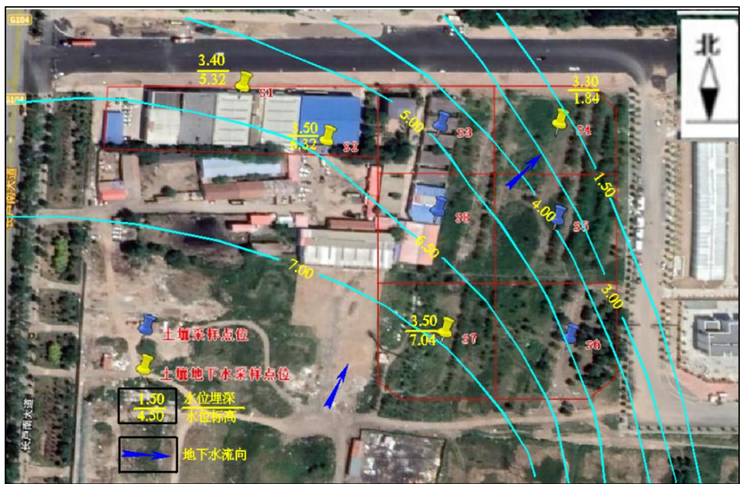
图 3-9 地下水水位等值线图
