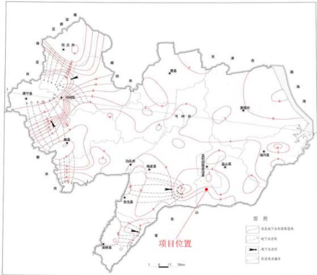
图 3-5 区域浅层地下水流向示意图
