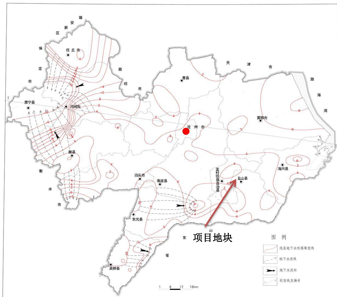
图 3-10 区域浅层地下水流向示意图
