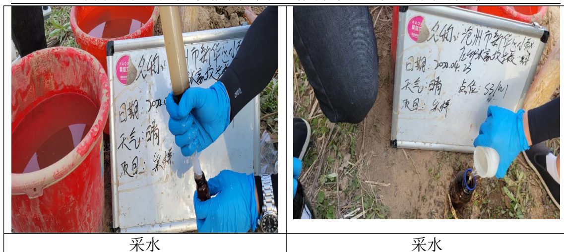
图4.2-3 地下水建井洗井、采样照片
